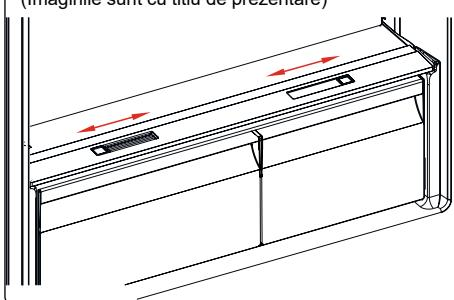
În cazul în care cutia pentru fructe și legume este complet plină, deschideți lamela pentru prospetime din fața compartimentului pentru fructe și legume. Aceasta va permite ca intrarea aerului din cutia pentru fructe și legume și rata umidității să fie controlată, pentru a crește durata de valabilitate a alimentelor din interior.
