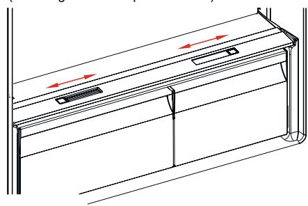
Si el cajón para fruta y verdura está lleno, el indicador de frescura ubicado en la parte frontal del cajón debe dejarse abierto. De este modo se controla el aire y la humedad que hay dentro del cajón para aumentar la vida de los alimentos que haya en su interior.
