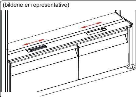
Hvis grønnsaksskuffen er helt full, bør ferskhetsbryteren, som er plassert foran grønnsaksskuffen, åpnes. Da vil luften og fuktigheten i grønnsaksrommet kontrolleres, og dette vil øke matens levetid. Bryteren som er plassert bak hyllen, må åpnes hvis man ser kondens på glasshyllen. Merk: Ikke legg matvarer på fuktighetsregulatoren.
