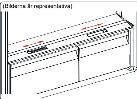
Om grönsakslådan är helt full bör färskhetsratten som finns på framsidan av grönsakslådan öppnas. Detta gör att luften och luftfuktigheten i grönsakslådan kan kontrolleras för att öka livslängden på maten där.
