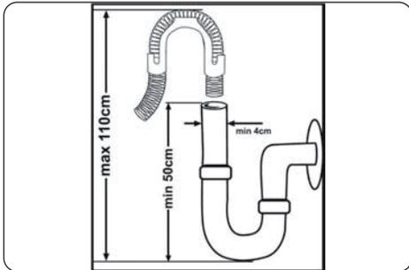
Ablaufschlauch direkt an den Abfluss anschließen. Anschlussstelle muss sich in einer Höhe zwischen 50 cm und 110 cm über dem Boden befinden.
