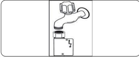
⚠ Einige Modelle werden mit Aquastop-System geliefert. Dieses nicht beschädigen und nicht knicken oder verdrehen.
